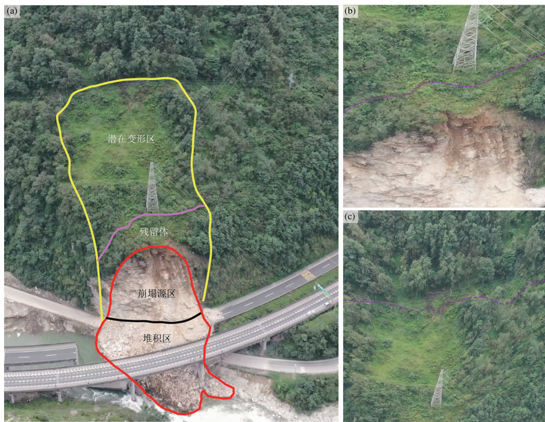
图4 崩塌分区图:(a)崩塌全貌;(b)残留体范围;(c)潜在变形区
