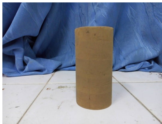
图3 三轴试验试样
