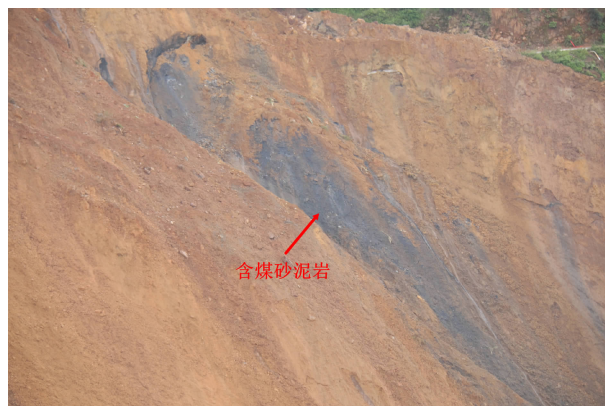
图4 古滑坡堆积的含煤砂泥岩
