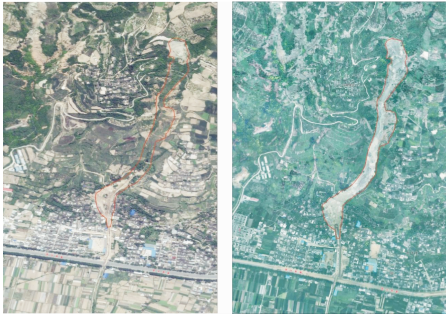
图4 大沟泥石流灾前灾后正射影像对比图
