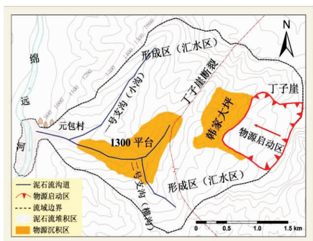
图4 文家沟泥石流深层滑坡示意图
