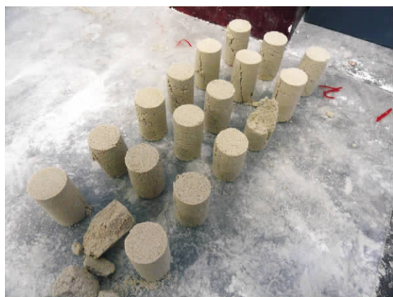
图3 试件单轴破坏形态
