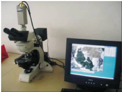
图 3 矿物成分图像分析 Fig. 3 Imaging analysis of mineral component
