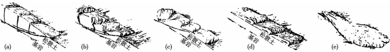
图 2 浅层滑坡转化为泥石流过程 (Howard [6] )
