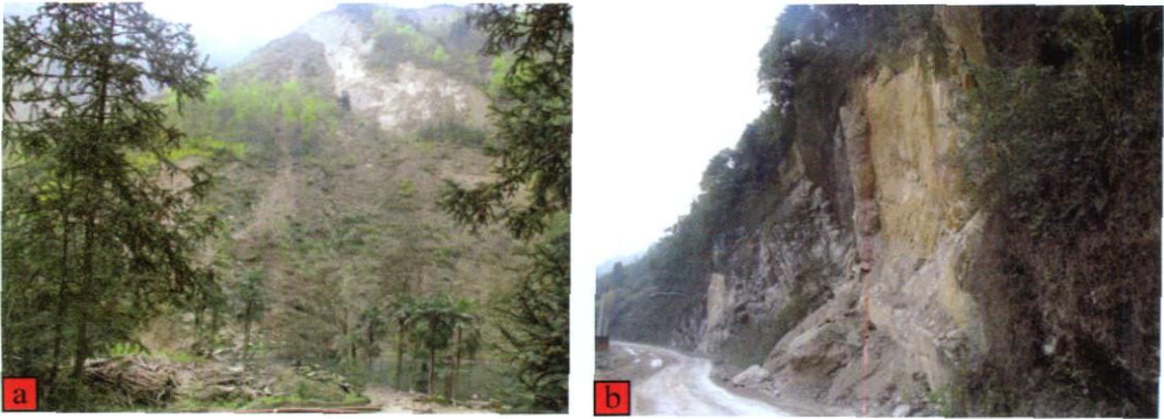
图8 a为干磨房顺层滑坡, b为反倾岩层中的崩塌
