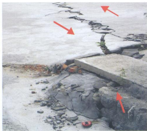
照片 6 南支断裂影响带宝莲寺走向 N60^\circ \text{ E} 的构造地裂缝
