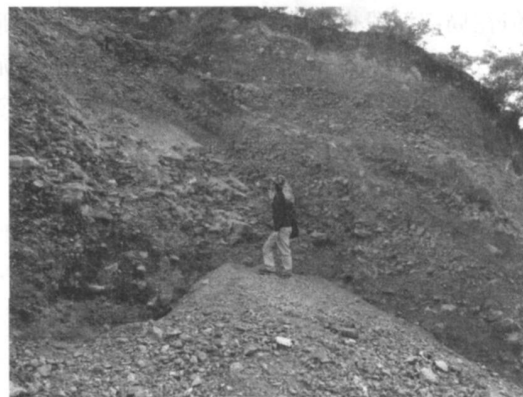
图 6 冰水堆积体前缘河流相覆盖层
