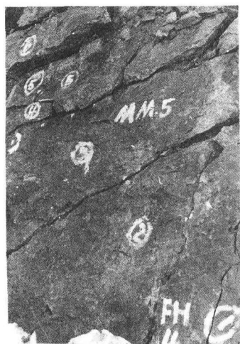
照片 11 乌鲁木齐—库尔勒公路胜利达坂南坡破裂的基岩(绢云母石英片岩)
