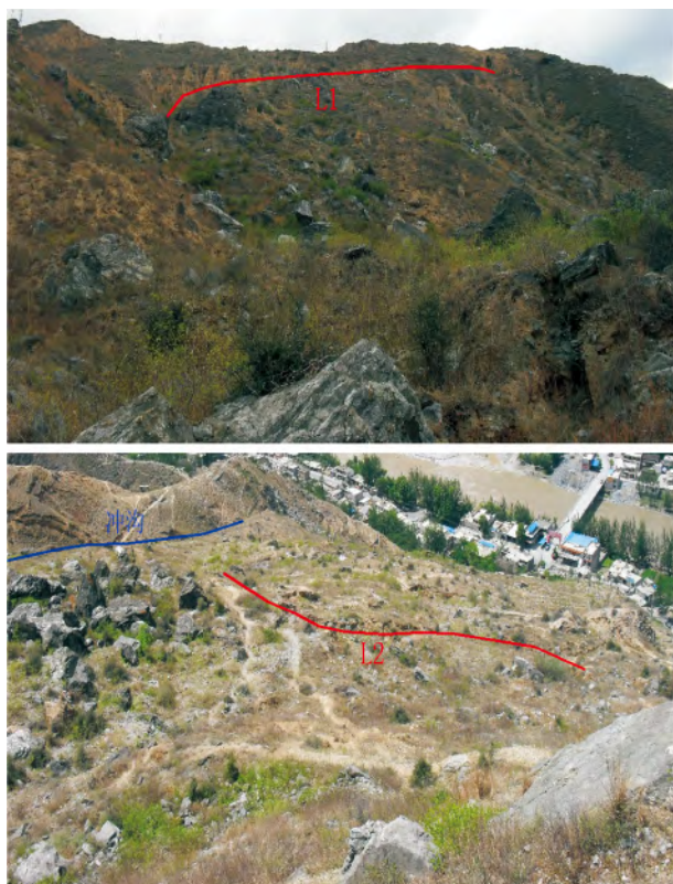
图3 地震后滑坡后缘、中部的拉裂缝
