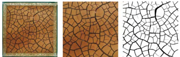
(a) 1 # 土样裂缝发育的最终形态 (b) 选取 30 cm×30 cm 区域 (c) 二值化图像 图 2 图像处理过程中不同阶段的土样裂缝图片 Fig.2 The soil samples images during different stages of picture processing
