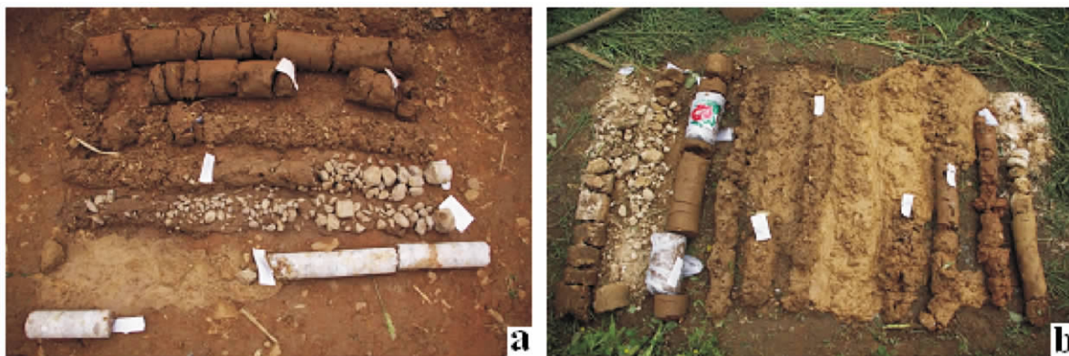
图 3 塌陷区钻孔岩芯
