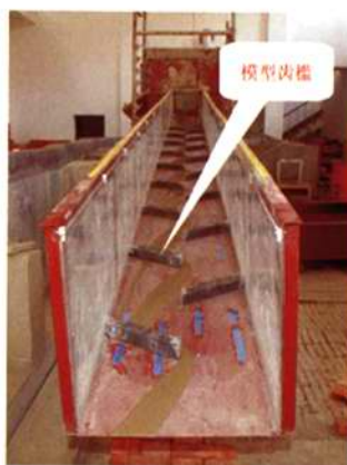
图2 交错齿槽布置
